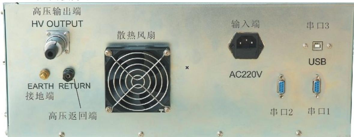
后面板主要包括：高压输出端、高压返回端、散热风扇、接地端、交流 220V 输入端、串口 1、串口 2、串口 3。
