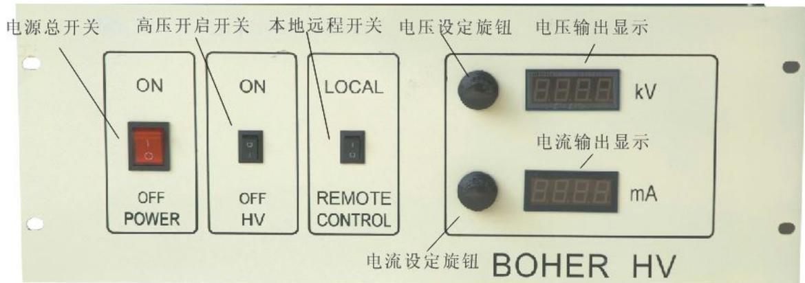
前面板主要包括: 电源总开关、高压开启开关、本地远程切换开关, 电压设定旋钮、电流设定旋钮、电压输出显示、电流输出显示。
