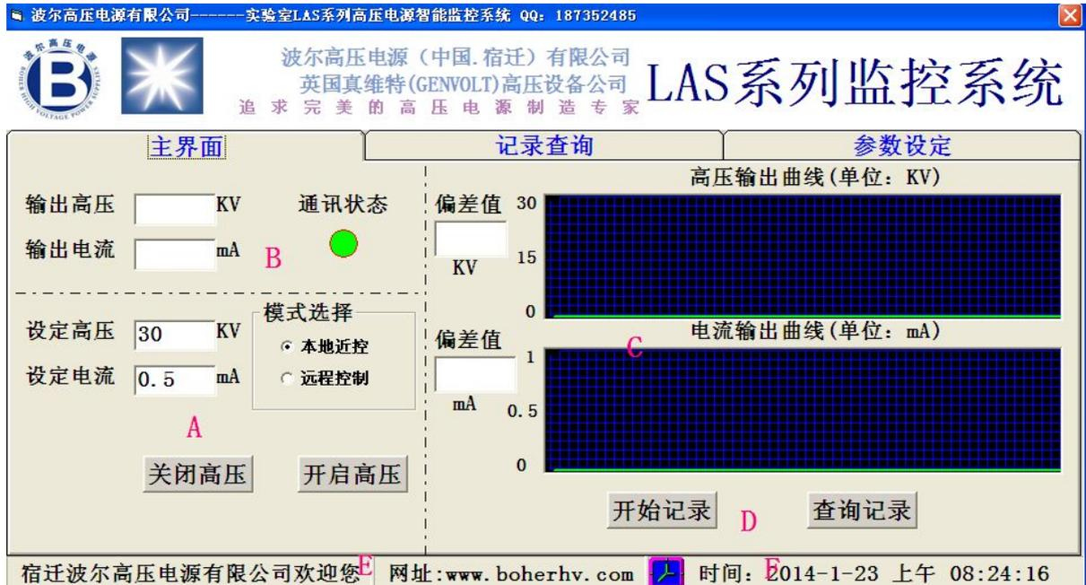
A 区：设定控制区，先选择远程控制模式，设定电源的输出电压、电流，然后单击开启高压，电源就可以输出对应的高压，电流（负载要合适，本电源是恒功率输出，过重的负载会导致输出电压偏低，过轻的负载将使电流偏小）
