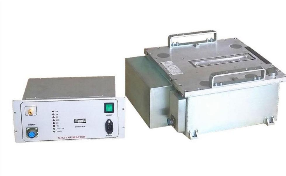
XRT03A 160kV X 射线源产品由控制器、射线源两部分组成。采用最新PWM 中高频脉宽调制技术，管电压、管电流高精度闭环控制；独有的电源输入预稳设计能有效消除电网波动的影响，使射线输出更稳定；设有过压、过流、过热等多种保护及良好的射线屏蔽。工作可靠安全，使用方便，出束稳定，射线泄漏剂量低。广泛应用于安全检查、食品检测、工业检测等领域。
