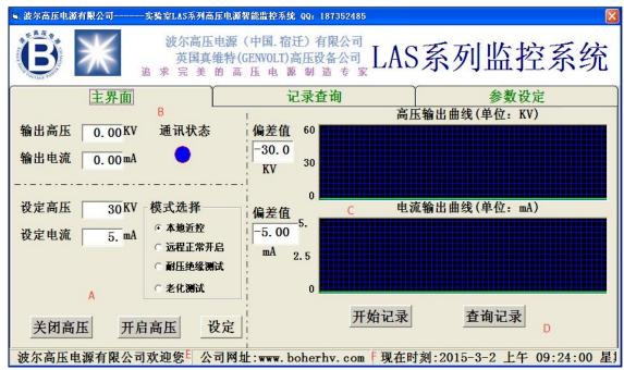
A 区: 设定控制区, 先选择远程控制模式, 设定电源的 输出电压、电流,然后单击开启高压,电源就可以输出对应 的高压, 电流。耐压绝缘测试以及老化测试功能可以在参数 设定中设定相关参数。(负载要合适,本电源是恒功率输出,过重的负载 会导致输出电压偏低,过轻的负载将使电流偏小)
