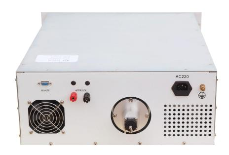
后面板主要包括: 高压输出端、散热风扇、接地端、交流 220V 输入端、串口 1、串口 2.(根据实际产品,后面板略有不同)
