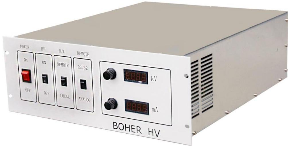
前面板包括：电源开关（POWER），高压启动开关（HV）、本地远程切换开关（R/L），远程模拟及远程通信切换开关（REMOTE），高压设定旋钮（kV），电流设定旋钮（mA），高压输出显示，输出电流显示。
