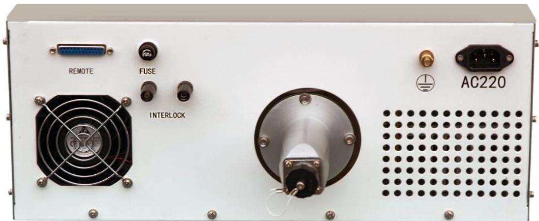
后面板包括：电源输入接口（AC220），高压输出接口，保险丝 FUSE（20A），互锁 INTERLOCK。DB25控制接口, 风机, 接地螺柱。
